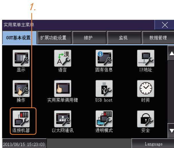
1. GOT 接通电源后，触摸实用菜单的 [ 主菜单 ] → [ 连接机器设置 ]。
