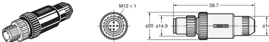
XS2G-D5S2 (5极、L型、适用电缆外径: 6mm)
