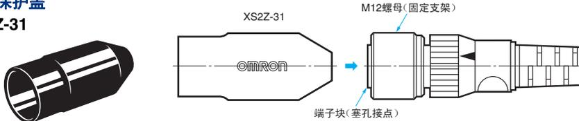
防溅保护盖保护接插件免受焊接喷射。
