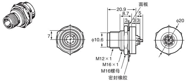
带焊帽端子和前锁的XS2P-D822-2面板安装插座 (M12)
