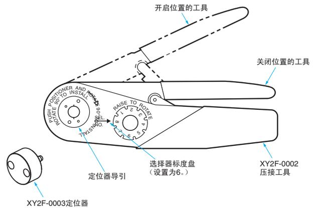
通过压接型接插件 (XS2C/XS2G), 将压接触头 (XS2U) 压接在电缆芯线上时使用。
