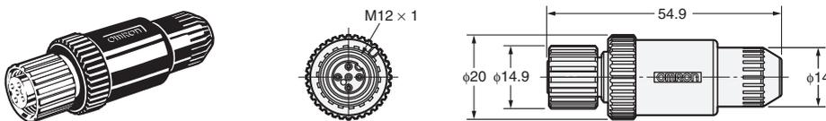
XS2C-D5S2 (5极、L型、适用电缆外径: 6mm)
