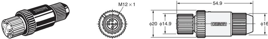
XS2C-D5S1 (5极、直线型、适用电缆外径: 6mm)
