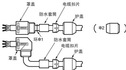
**5极型（XS2C-D5S□、XS2G-D5S□）随附绝缘盖与绝缘管。**
