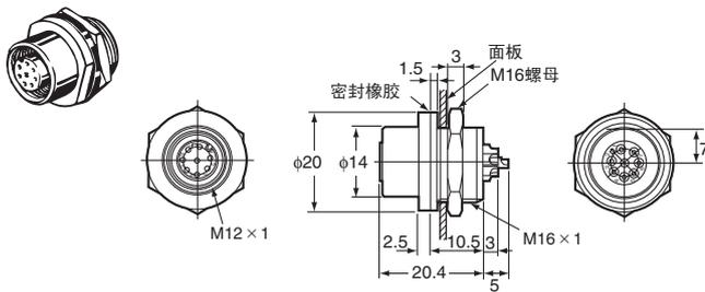
带焊帽端子和前锁的XS2M-D824-4面板安装插头 (M12)
