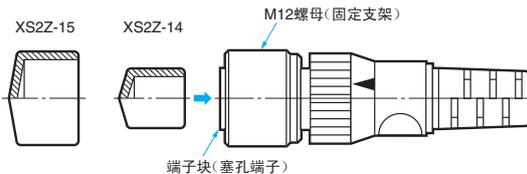
防尘盖用于阻止灰尘，不能确保IP67级保护。将防尘盖安装到接插件时，请确保将防尘盖向接插件上压，直到接插件完全插入防尘盖。
