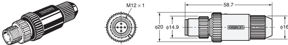
XS2G-D5S1 (5极、直线型、适用电缆外径: 6mm)
