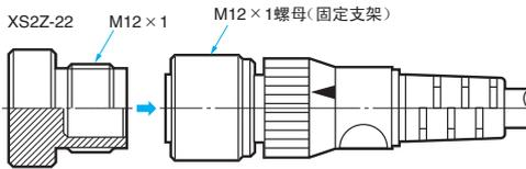
接插件未接合状态时，使用此防水盖能确保保护等级 IP67。将防水盖安装到接插件时，请确保使用 0.39 到 0.49N·m 之间的扭矩来拧紧防水盖。
