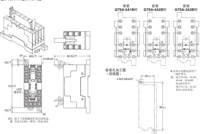
端子配置/内部连接图(顶视图)
