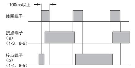
注: 线圈追加脉冲使用时, 请使用施加脉冲100ms以上。
