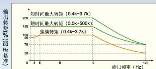
无传感器矢量控制的转矩特性例 使用电机SF-JR 4P (220V输入时)
